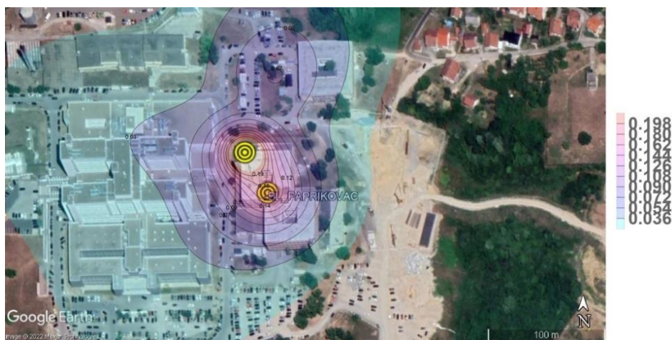
Сл. 14.13. Контуре изложености на висини 2 m изнад тла у односу на граничне вредности за општу популацију у околини базних станица инсталираних на УКЦ Републике Српске
